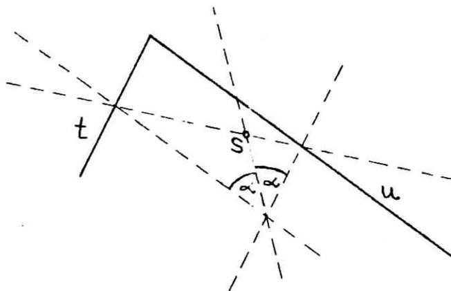
Bestimme die Gerade durch die Mittelpunkte (Schwerpunkte) der Strecken  $t$  und  $u$ . Deren Schnittpunkt mit der obig eingezeichneten Winkelhalbierenden des abgebildeten Parallelogramms legt den Schwerpunkt fest.
